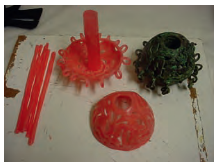
Registro de las diferentes etapas tecnológicas de la reproducción de la cabeza de maza de metal moche. Fotos Andrea Torres.
