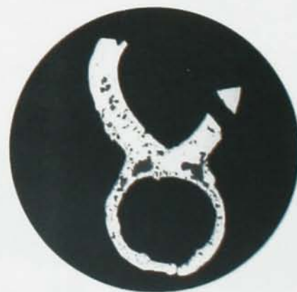
Fig. 2: Microfotografía de un corte longitudinal del cascabel.
