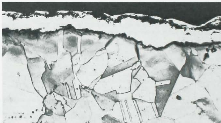
Fig. 2: Microfotografía de una muestra de un borde festoneado de la cabeza del bastón.
